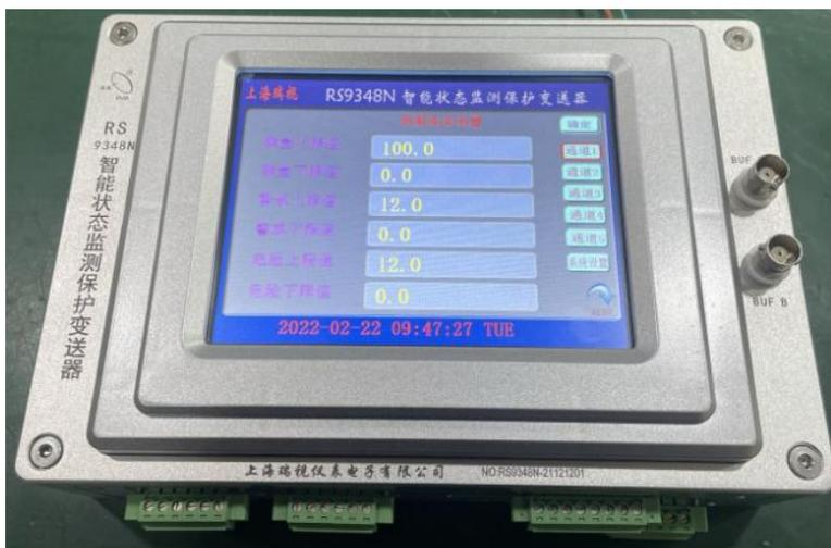
在菲尼克斯端子排“OUT 和 GND”之间串入电流表可以查看每个测量值对应的电流输出。具体计算方法如下：我们组态的振动类型为轴振，量程为100um，当轴振值为60um时，对应的电流输出为13.6mA（ $(20\text{mA}-4\text{mA})/100*60+4\text{mA}=13.6\text{mA}$ ）。具体显示如下：
